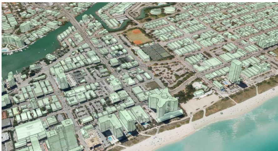
Figure 1-3-1-1 – Reconstruction automatique de modèles 3D à partir d'acquisition LIDAR
