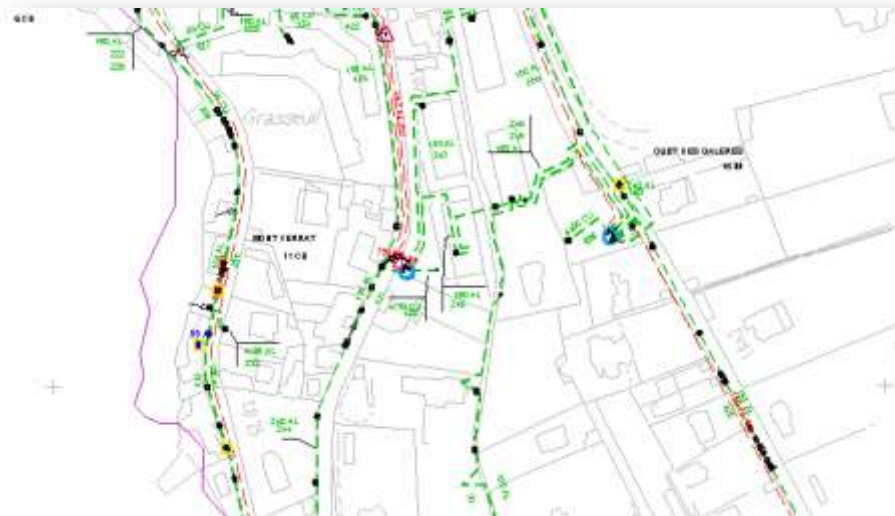
Etat initial SIG ERDF : le réseau est positionné dans l'emprise de voie du fond de plan actuel (cadastre local)
