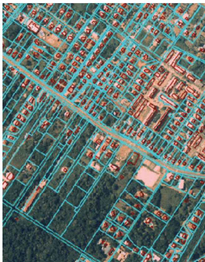
Superposition d'un plan cadastral et d'une orthophoto dans un SIG.
